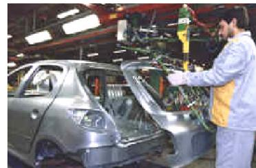
l'atelier est moins mécanisée et des opérateurs interviennent pour ajuster les ouvrants. Cet atelier engage les ordres de fabrication dans l'ordre qui a été initialement calculé.
