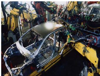
soudures, réalisées par des robots, pour fabriquer la « caisse en blanc ». La deuxième partie de
