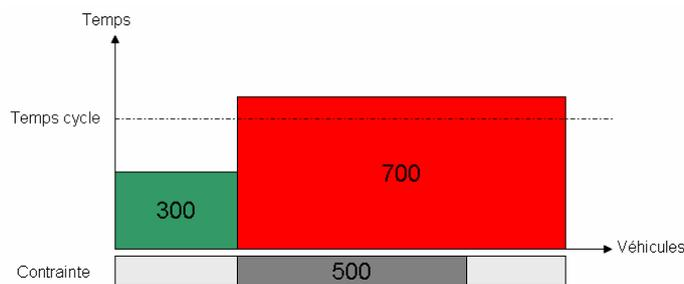
Figure 3.11 : Poste sous contraint par une contrainte
